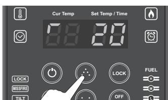
4. В процессе работы обогревателя все индикаторы и команды высвечиваются на дисплее обогревателя. Включение и Выключение обогревателя начинается с кнопки Вкл/Выкл. После того как вы нажмёте кнопку (Выкл.) на дисплее вместо знака температуры отобразится значок (- -). В таком режиме обогреватель полностью отключится через 5 минут. Если обогреватель работает в режиме (Таймера) после нажатия кнопки (Выкл.) обогреватель полностью отключится через заданное, на дисплее времени (Таймера) + 5 минут.
