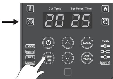
3. При установке обогревателя в режим температуры можно регулировать, понижать или повышать температуру соответствующими кнопками (▼▲). Чтобы задать необходимую температуру нажмите на кнопку (Температура/Время). Выберите положение (Температура) на дисплее загорится индикатор (Температуры). Задайте температуру путём нажатия на кнопки (▼▲). После установки заданной температуры подождите 3 секунды, чтобы температура установилась. Для повторной установки температуры проделайте ту же самую процедуру.
